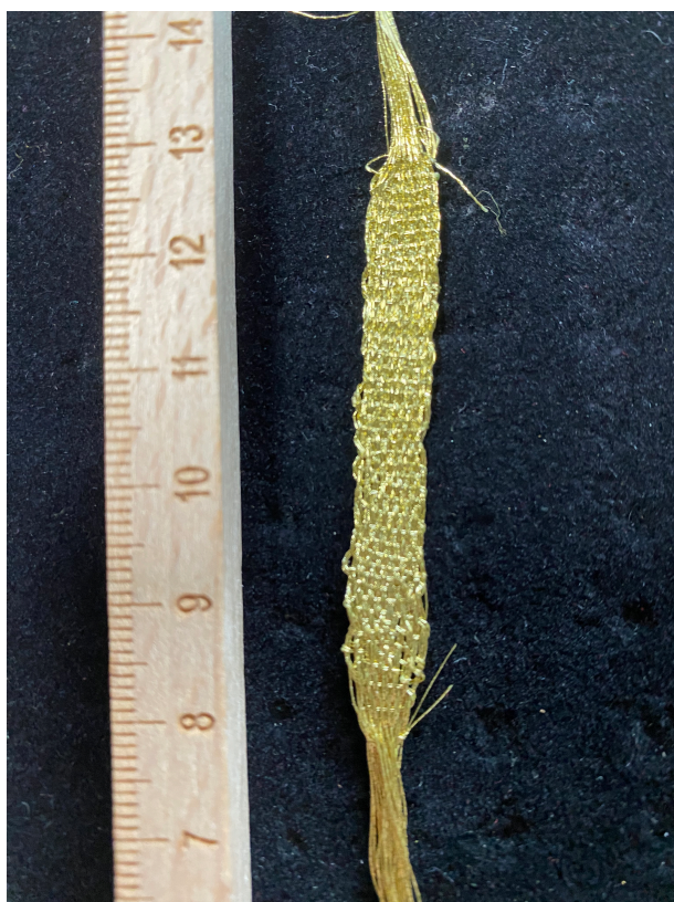
Figura 3a): Esperimento 4, filo d'oro 'Anchor' (1970) per ricamo, 0,1 mm, 52 fili di ordito, trama Tabby 4/2 (©Lorena Ariis).
