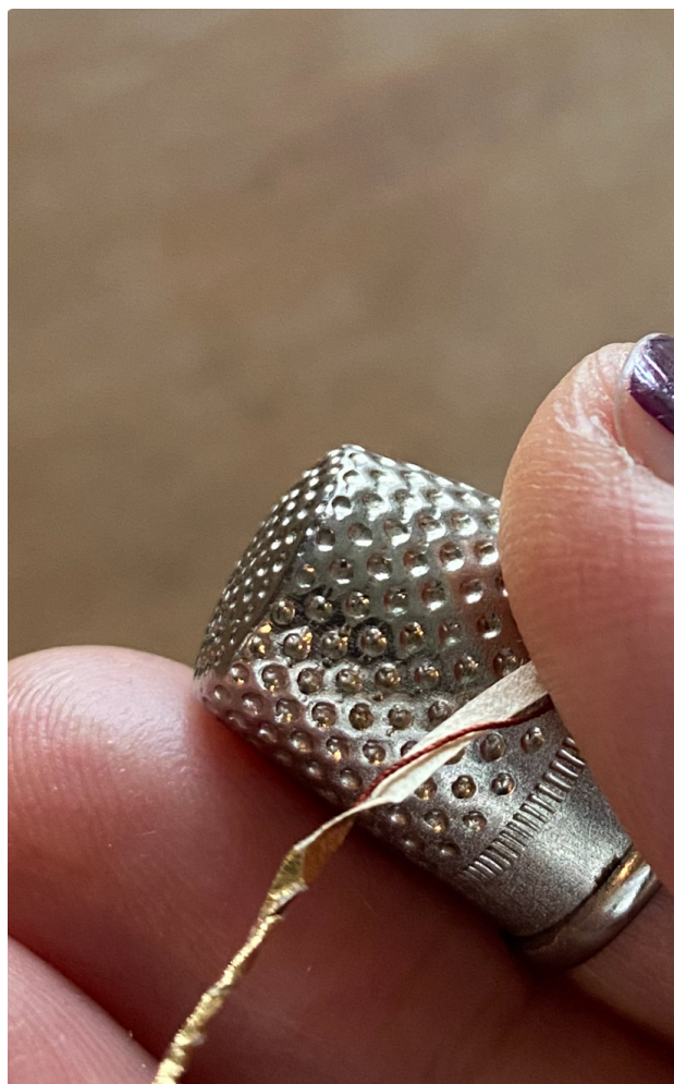
Figura 1f) Filatura della lamella su seta attraverso l'uso di un ditale (©Lorena Ariis).
