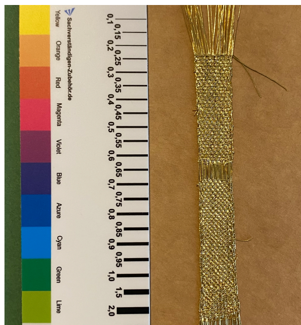
Figura 2b) Esperimento 3, Filo da ricamo Industrial gold (fil d'or Broder n.10, 1920) e seta, in armatura Tabby 2/1 e 2/2 (©Lorena Ariis).
