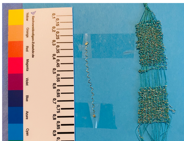
Figura 2c) Esperimento 2, filo lamellare francese avvolto su seta da cucire di 0,3 mm, in tessitura Tabby 2/1 e 2/2 (©Lorena Ariis).
