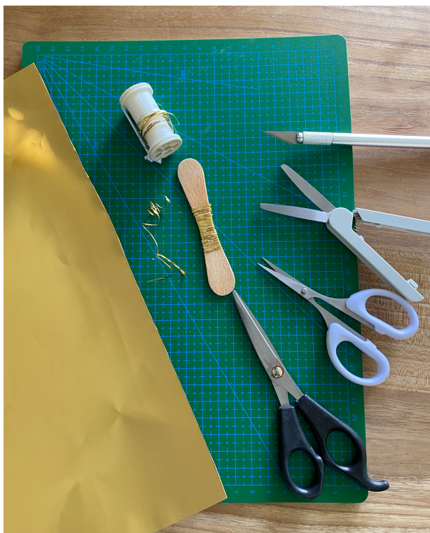
Figura 1a:) Taglio della lamella da un foglio di alluminio placcato oro. Prove con vari tipi di lame (©Lorena Ariis).
