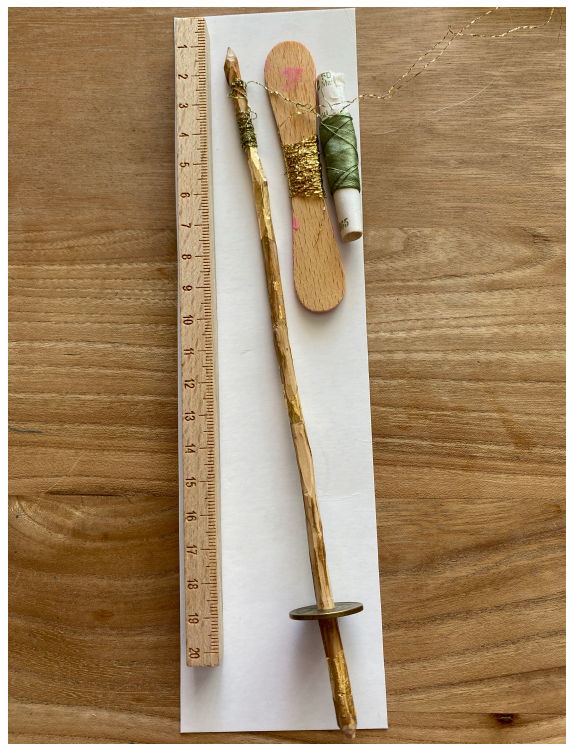
Figura 1d) Il fuso leggero Tahkli, realizzato dall'autore, utilizzato per avvolgere-filare. (©Lorena Ariis).
