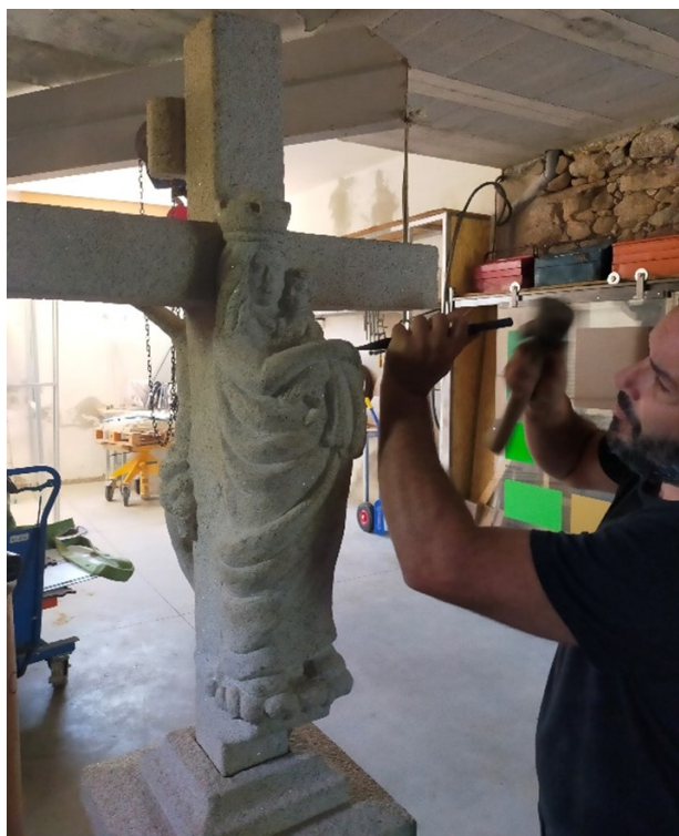
Figura 7: Il lapicida Rodrigo G. Xiráldez inclina a 90° gradi la punta, colpendola con il percussore metallico nell'officina di Vigo (Pontevedra).
