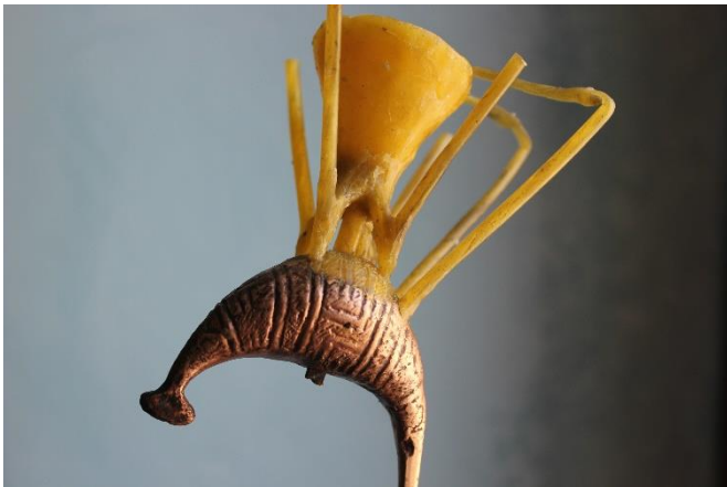
Figura 4: Terza fase della riparazione: il modello in cera è completato con sfiati, canali di immissione e cono d'entrata allo scopo di ottenere una integrazione con la tecnica della fusione secondaria
