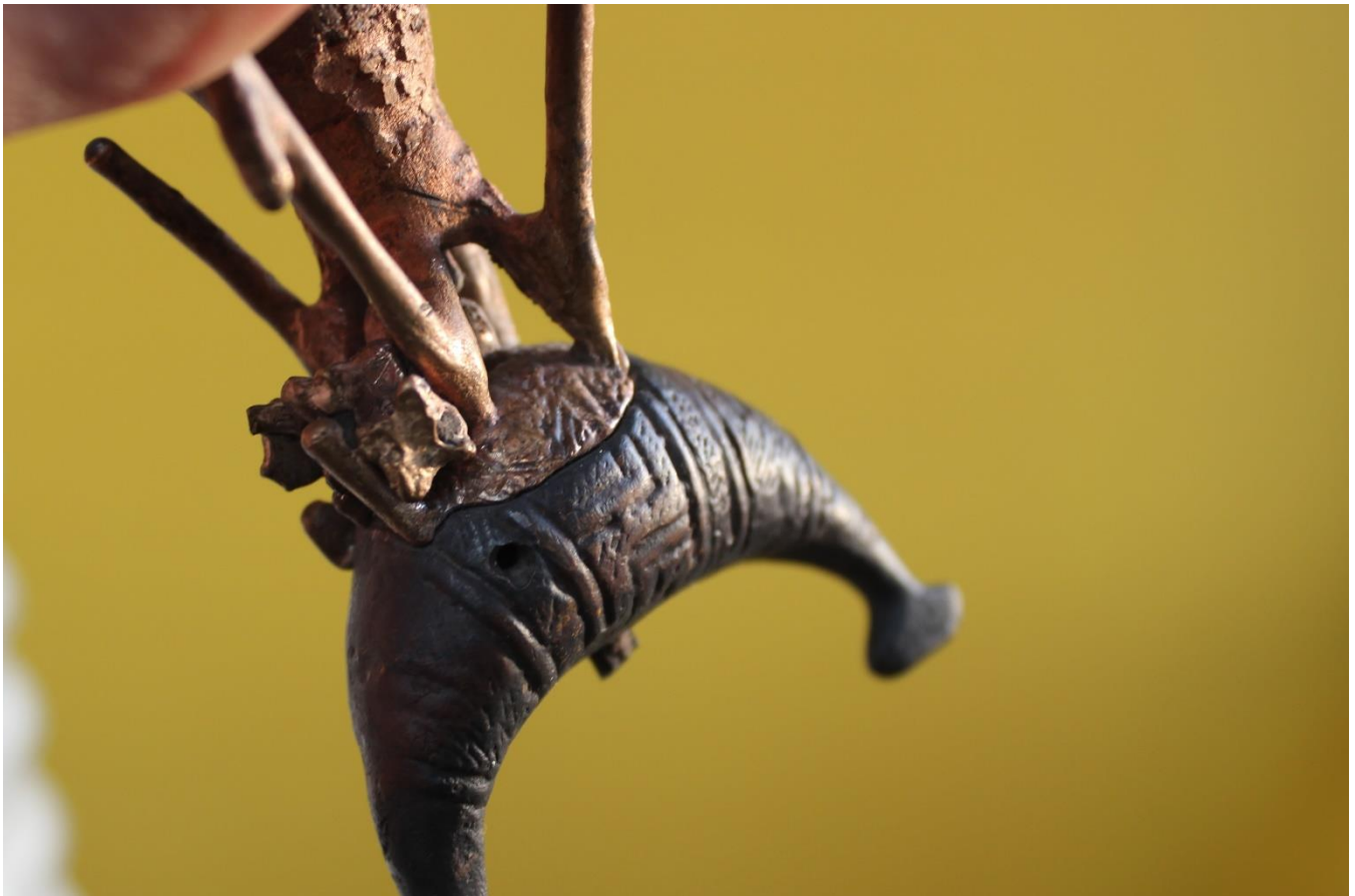
Figura 5: Quarta fase della riparazione sperimentale: toppa grezza ottenuta tramite fusione secondaria
