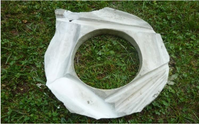
Figura 41: Mola moderna a grani di quarzo dieci volte più abrasiva della mola di arenaria del bergamasco e cinque volte più abrasiva della mola in arenaria del Neckar e della mola in granati di Chiomonte.
