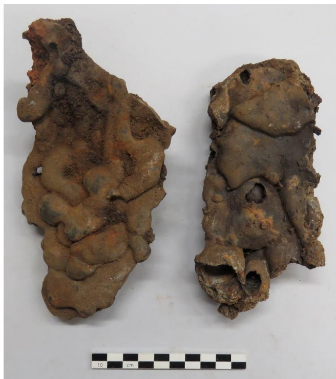
Figura 8: Scorie di colata dette anche "placche a ventaglio" per la caratteristica conformazione, prodotte dall'espulsione della scoria fluida dal forno durante il suo funzionamento.
