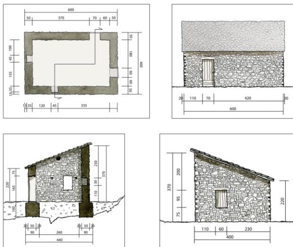
Figura 6: Le tavole di progetto per la ricostruzione della casa.
