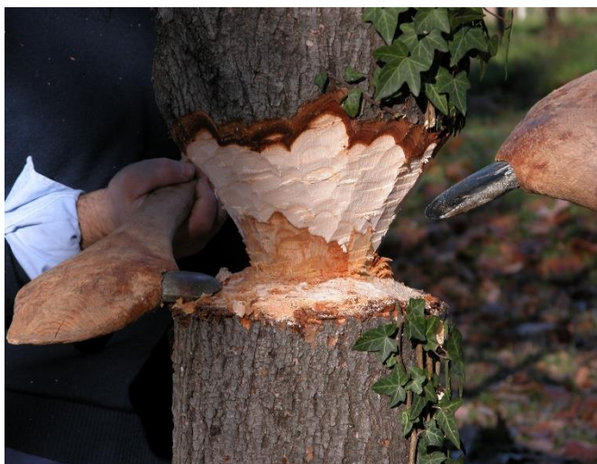
Figura 58: Abbattimento di un olmo con accette.
