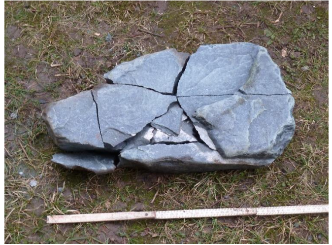
Figura 16: Grosso blocco di Eclogite spezzato con il fuoco.
