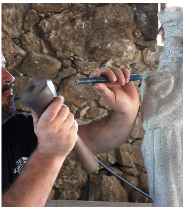
Figura 6: Il lapicida Rodrigo G. Xiráldez usa la 'mazzetta rotonda' o 'mazzetta portoghese' nell'officina di Vigo (Pontevedra) (foto di S. Brangi).
