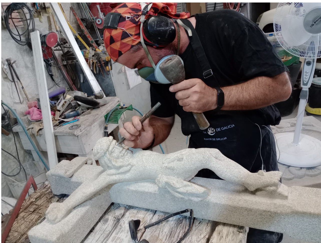
Figura 20: Il lapicida Miguel Angel Fandiño Gondar mentre utilizza mazza rotonda e subbia nella propria officina di A Coruña (foto di S. Brangi).
