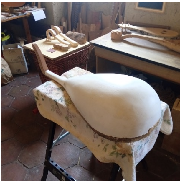
Figura 15: Imprimatura in gesso.
