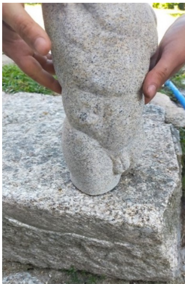
Figura 5: Confronto tra due tipi di granito nell'officina del lapicida Rodrigo G. Xiráldez. L'elemento scolpito ha una granulometria ridotta rispetto al blocco sottostante ed è quella maggiormente utilizzata per i cruceiros (foto di S. Brangi).
