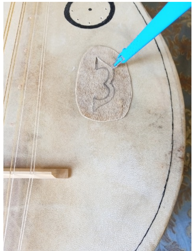
Figura 26: Incisione delle buche con un bisturi.
