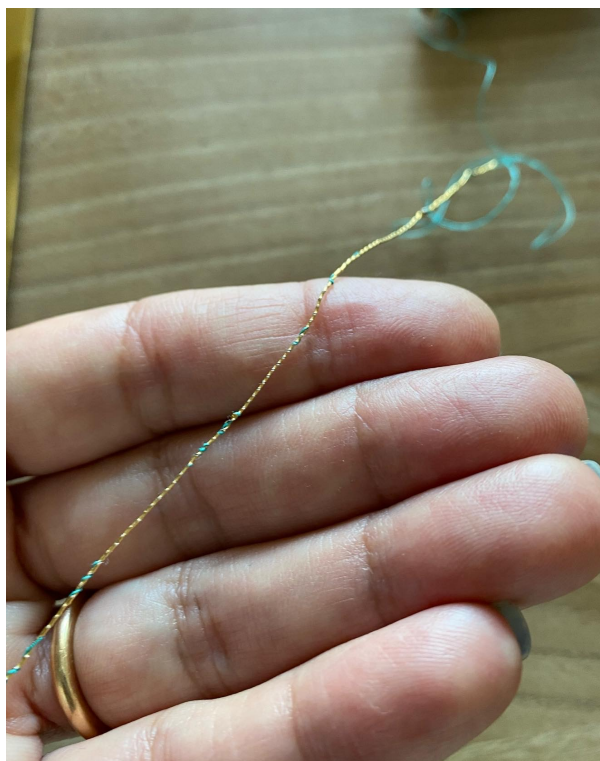
Figura 1b): Lamella di alluminio avvolta su filo industriale 100% seta (©Lorena Ariis).
