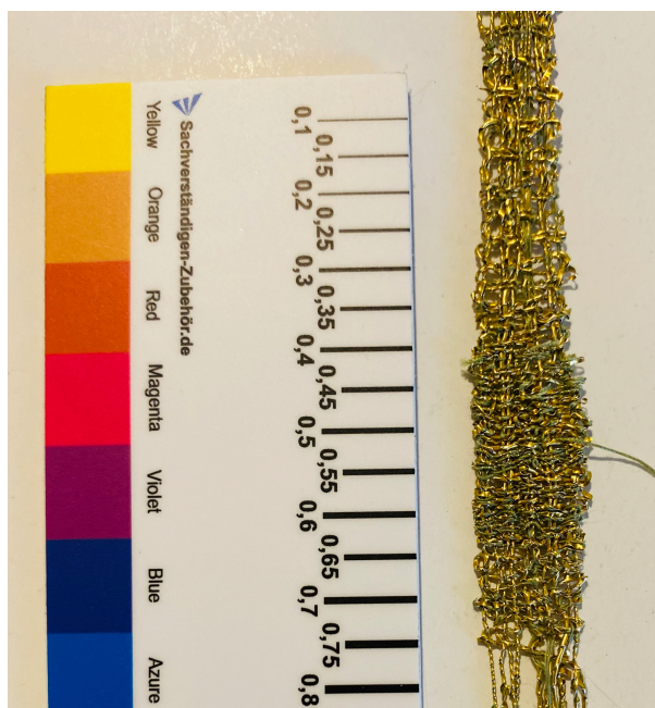
Figura 2a): Esperimento 1, striscia di alluminio dorato avvolta su seta da 0,1 mm, trama Tabby 2/1 e 2/2 (©Lorena Ariis).
