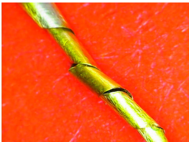
Figura 1e) Ingrandimento X200 della lamella di alluminio ritorta su filo di seta (©Lorena Ariis).
