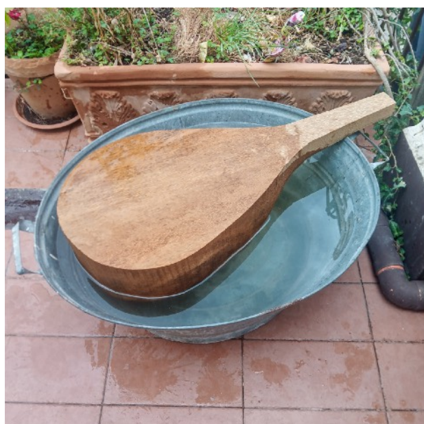
Figura 5: Blocco sagomato immerso in acqua.
