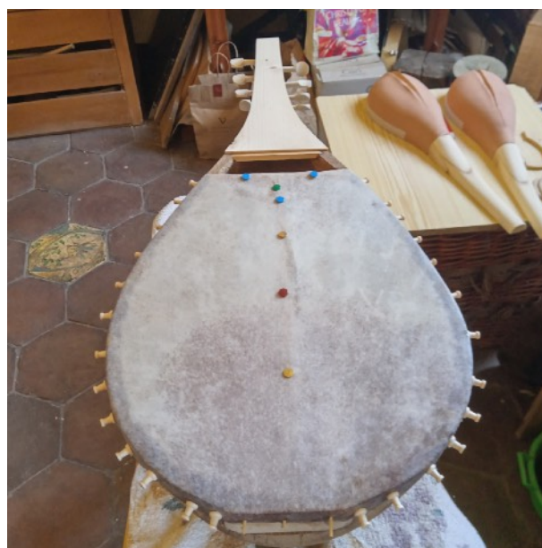
Figura 12: Incollaggio della pelle.
