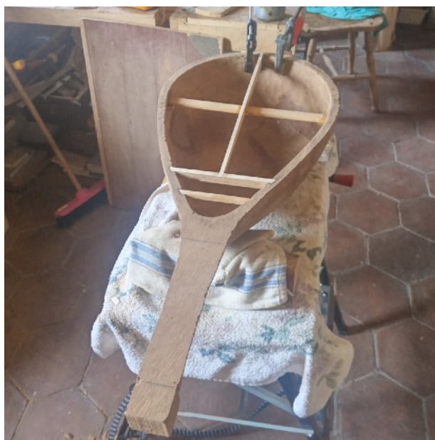
Figura 10: Aggiunta dei rinforzi interni.
