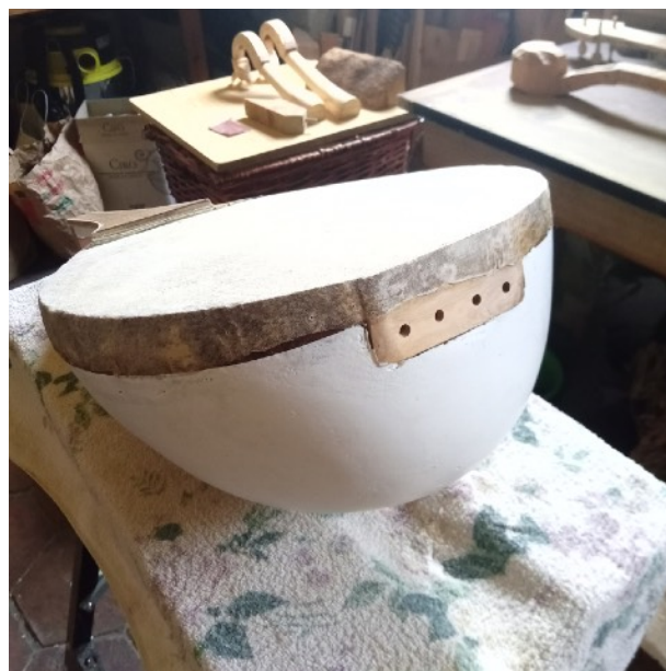
Figura 16: Rinforzo in olivo per l'aggancio delle corde.
