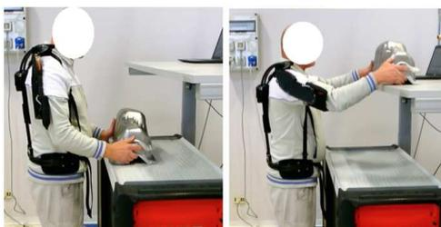
Fig.3 – Istantanee prova dinamica con esoscheletro
