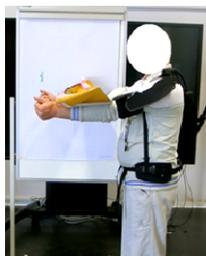
Fig.2 – Istantanea prova statica con esoscheletro
